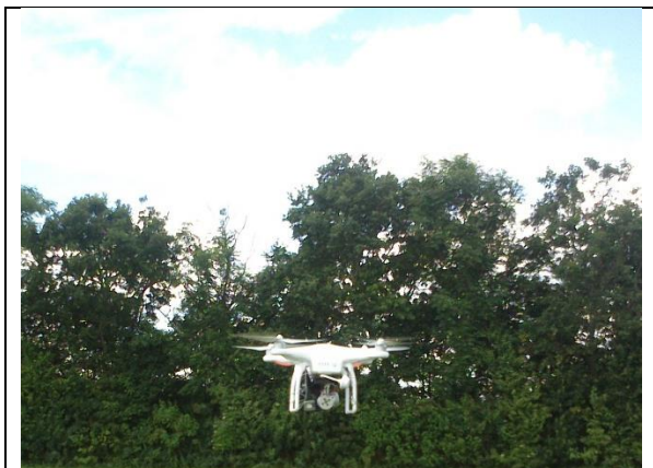
Phantom fra droner.dk med både termisk kamera og RGB kamera. Flyet er let at manøvrere og let udskiftning af batteri
